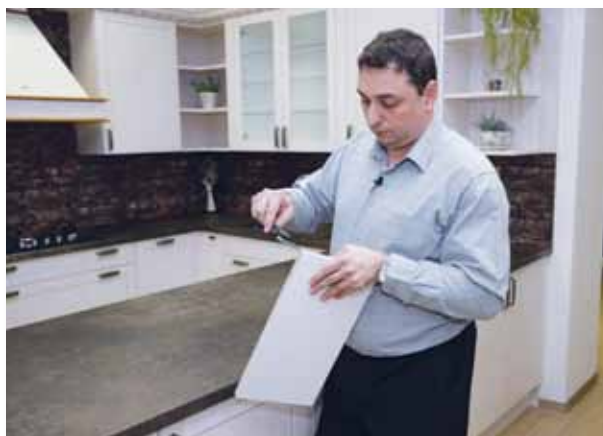
ověřovací měření tloušťky povrchového akrylátu u dvířek T.acrylic
