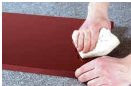
4. krok poškozené místo vyleštíme jemným hadříkem
