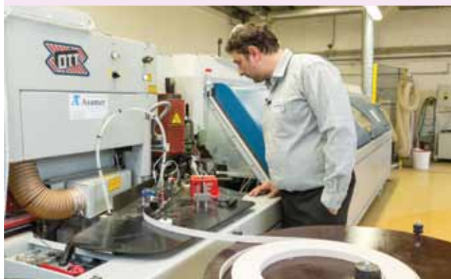
vysoce kvalitní PUR technologie hranění dvířek
