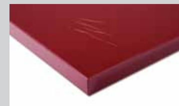
lesklý akrylátový povrch s jasně viditelným poškozením
