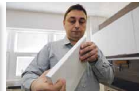
akrylátová dvířka s PUR lepidlem po sedmi dnech, bez známek rozklížení
