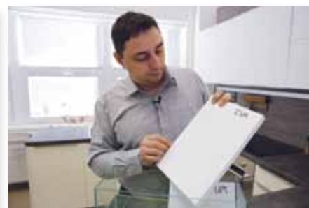
akrylátová dvířka s EVA lepidlem po sedmi dnech, rozklížená spára a nabobtnalá hrana
