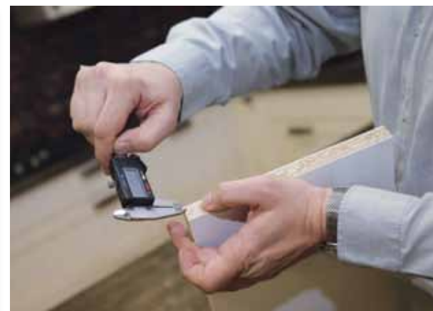
potvrzena odpovídající tloušťka 1,43 mm
