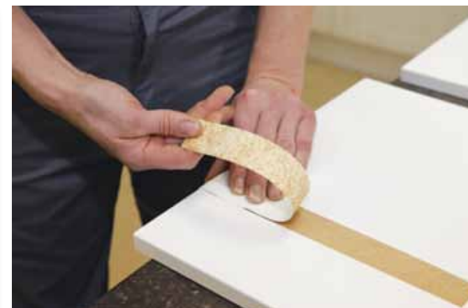
detail zadní strany strhávaného pásku s přilepeným MDF materiálem (Trachea)
