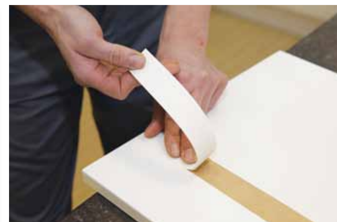
detail zadní strany strhávaného pásku s téměř nulovým MDF materiálem = vadná dvířka (neznačkový výrobce)
